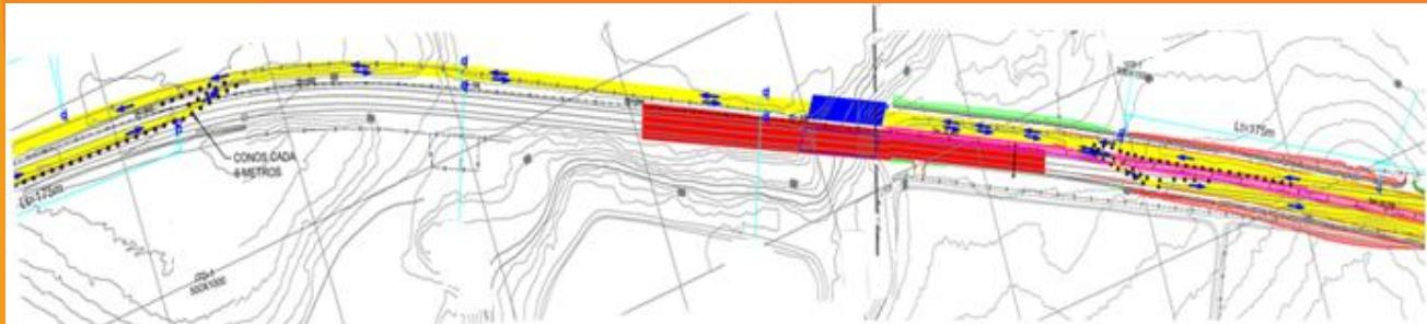
Las labores corresponden a la readecuación del Puente Puchuncaví, ubicado en la ruta F-20, entre los kilómetros 25 y 25,5 y es permitir el tránsito seguro y fluido de los usuarios, permitiendo la ejecución de las obras correspondiente al lado sur del trazado, ya sea para la estructura, como para el saneamiento y drenaje, tierras y asfalto.
